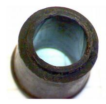
Le raccord casse au point faible : l'épaisseur de 2mm se réduit à 0,8mm pour former une gorge dans laquelle glisse la bague de verrouillage entre les deux moitiés.
