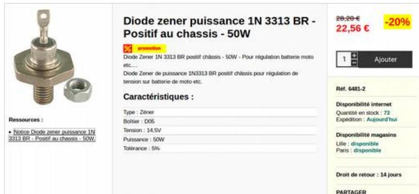
On voit clairement que c'est une petite diode montée sur un gros écrou !
