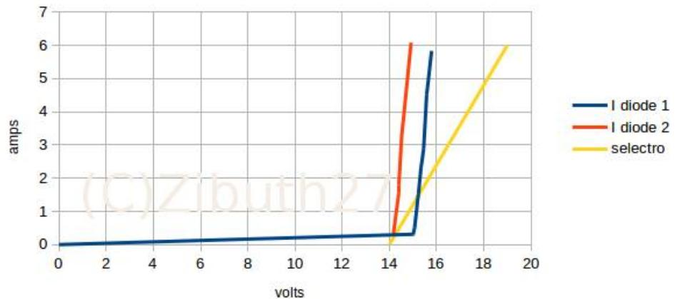
La tension mesurée sur la zener est de 15,94V à 2500rpm. Le courant crête est donc supérieur à 6A, ce qui correspond déjà à une puissance de 95W. À régime max, la dissipation augmente encore !
