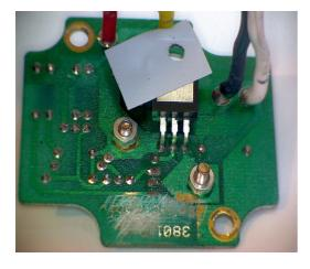
mauvais positionnement du film isolant grattage inexpliqué du PCB
