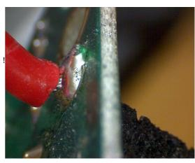
Les brasures des fils sont à REFAIRE et agrandir les trous pour que le fil traverse, même brasé sur le dessus. Cela permet un alignement des fils avec les trous dans le radiateur, et donc évite le forçage.
