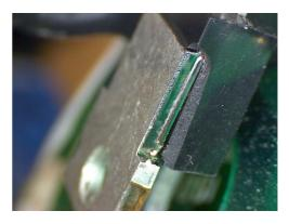
Transistor extrait par coupure des broches, donc sans action sur les broches
