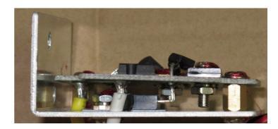
Les fils sont presque bien brasés. Le passage au travers du radiateur est presque correct. Mais les fils ne peuvent pas traverser le PCB, le trou est toujours trop petit.
