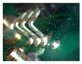
Le transistor vissé au radiateur est cambré avec un rayon trop faible et a créé des fissures dans l'électrode NON **CONFORME**
