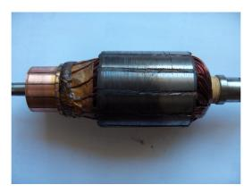
Point 15 : ça c'est le rotor tout neuf aprés 50 bornes avec selectronic ,dont 5 minutes en codes ....là ou les fils du bobinage sont soudé au collecteur l'étain a fondu et c'est centrifugé dans le cul de la dynamo
