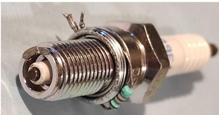
La résistance ne sert que pour avoir un pont facilement soudable ou attrapable par croco, en faible courant
