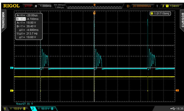
l'interface fonctionne largement au-delà des 6000rpm (200Hz), ici à 213Hz (6400rpm)
