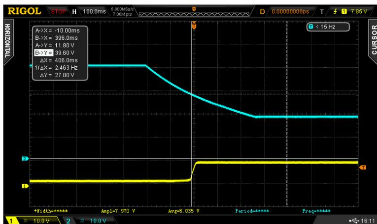
déclenchement de l'interface à 39V (je l'ai fait en baissant la tension pour une mesure plus propre, avec mon alim de labo)
