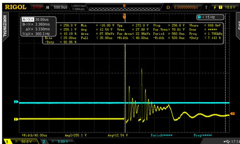
La sécurité intrinsèque par Zener du transistor de sortie Velleman ou IGBT irgb14c4) dans le transistor de sortie provoque parfois des doubles allumages, avec perte d'énergie à la bougie. le premier est avorté ( le première crête est faible et on ne sait pas l'efficacité de l'étincelle possible) et dure 500 $\mu$ s. Le second dure une milliseconde, mais intervient 500 $\mu$ s plus tard, soit 9° plus tard que prévu à 6000 rpm !
