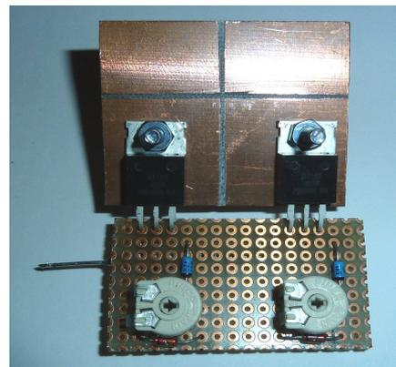
Comme il s'agit d'une sécurité supplémentaire, ce montage ne dissipera pas la totalité de la puissance à éliminer. Il faut mettre un radiateur suffisant aux thyristors, attention les anodes sont à isoler de la masse!
