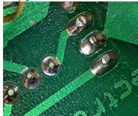
Flux de brasure nettoyé sur l'ensemble du PCB sauf pour les éléments rapportés (gros fils et transistor TIP41) ce qui peut entraîner des problèmes de corrosion à long terme et des fuites de courant sensibles à l'humidité, pose problème si circuit à haute impédance. **NON CONFORME**, mais sans doute pas trop grave ici.
