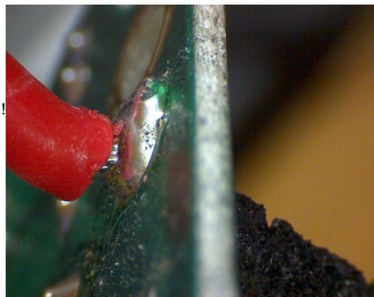
Les brasures des fils sont à REFAIRE et agrandir les trous pour que le fil traverse, même brasé sur le dessus. Cela permet un alignement des fils avec les trous dans le radiateur, et donc évite le forçage.
