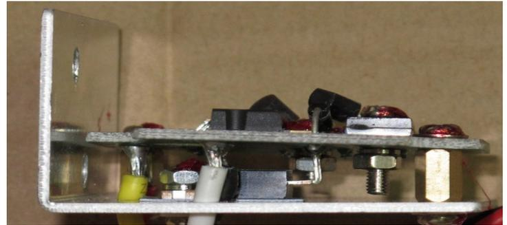
Les fils sont presque bien brasés. Le passage au travers du radiateur est presque correct. Mais les fils ne peuvent pas traverser le PCB, le trou est toujours trop petit.
