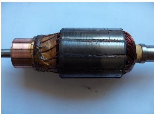
**Point 15** : ça c'est le rotor tout neuf après 50 bornes avec selectronic ,dont 5 minutes en codes ....là ou les fils du bobinage sont soudé au collecteur l'étain a fondu et c'est centrifugé dans le cul de la dynamo
