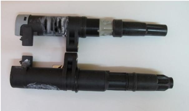
Figure 4.2: bobines X... et Beru
