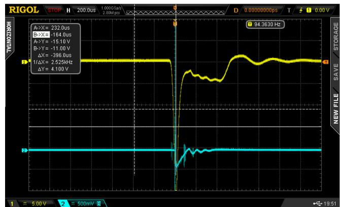
Figure 3.18: mesure du courant bougie
