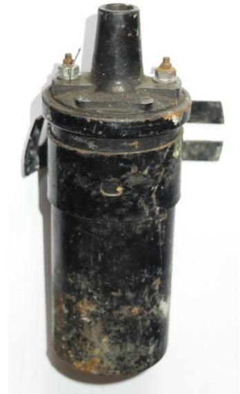
Figure 3.4: une (très) vieille bobine Ducellier des sixties
