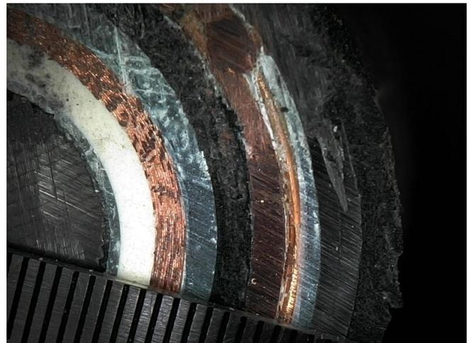
Figure 4.11: bobine Beru, détail de la coupe
