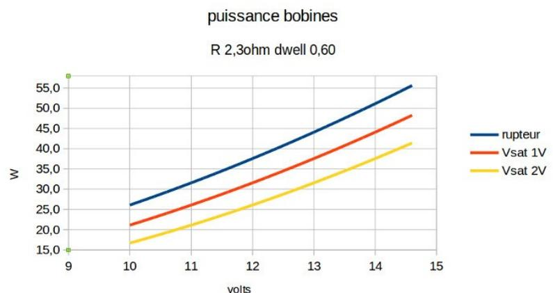
Figure 1.3: puissance bobine et tension déchet
