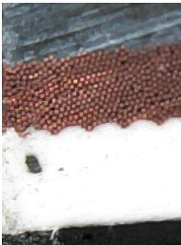
Figure 4.13: bobine Beru, foisonnement des fils
