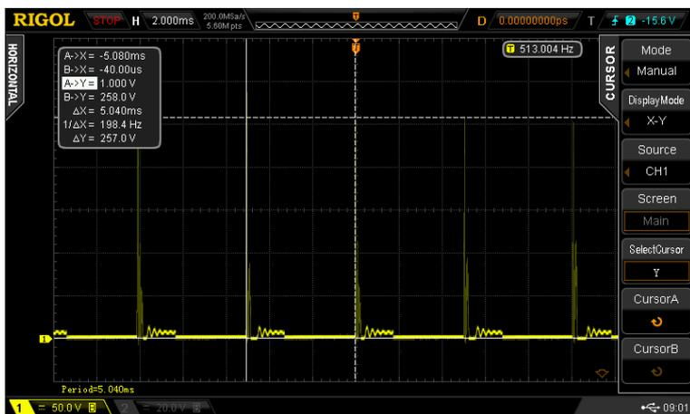
Avec 0,22μF, la bobine peut aller à 12 000 rpm et plus
