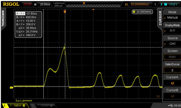
Avec une capa de 0,11F, la tension primaire passe à 350V et met 30μs avant amorçage
