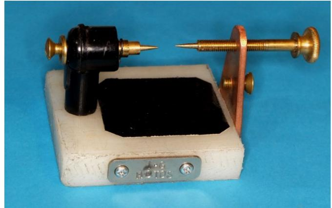
Figure 1.8: Éclateur de mesure fait par IGM
