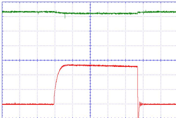
Figure 3.16: Ducellier, secondaire en court-circuit
