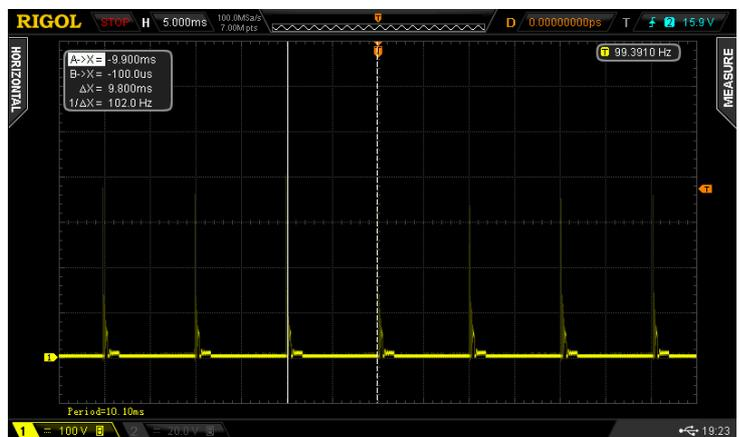
Figure 6.6: bobine SEV Solex, à 6000 rpm
