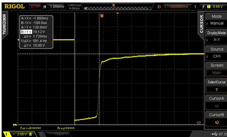
Figure 6.1: bobine Magneti Marelli charge magnétique
