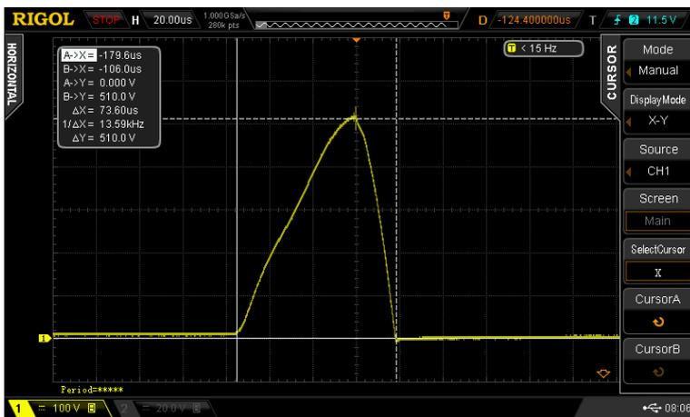
Figure 6.10: bobine SEV 12V 0,22µF écl 10mm
