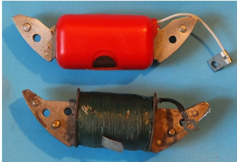
Figure 6.16: bobines VSX et SEV, de dessous
