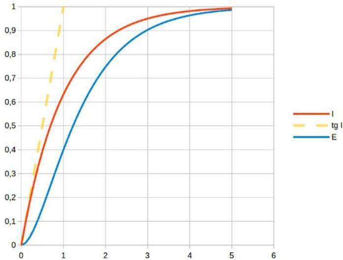
Courbe de la montée du courant de bobine et énergie correspondante en fonction de la constante de temps  $\tau$
