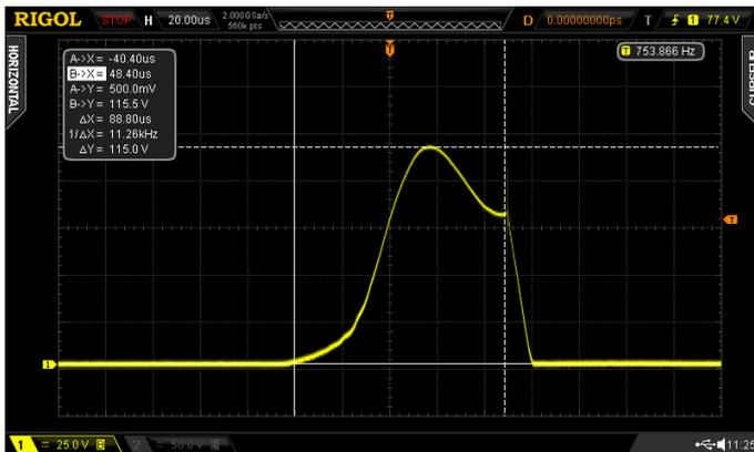
La bobine Ducellier avec une capa de  $0,22 \mu\text{F}$  a une tension crête de 115V et un retard d'allumage de  $90 \mu\text{s}$
