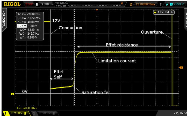
Figure 1.6: charge magnétique de la bobine à commande de courant
