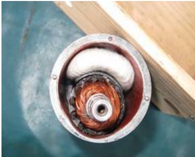
Le chignon, à noter l'entrefer de 1mm et le décentrement de conception
