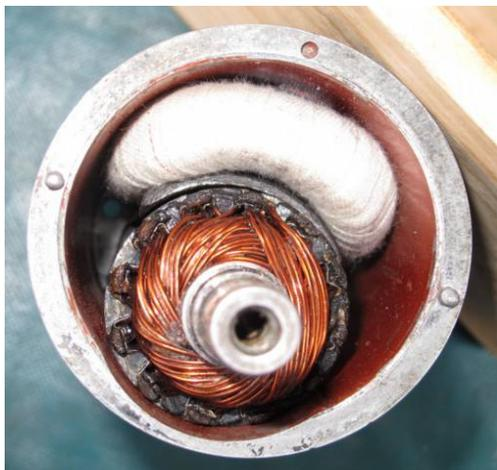
vue de l'excentricité et du bobinage unique d'inducteur, le premier pôle est constitué par l'inducteur (protégé par la toile blanche) et son noyau magnétique en fer, à peine visible, le second pôle est constitué par la saignée dans le corps magnétique.
