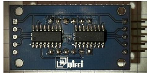
Les modules d'affichage sont sérialisables par simples câbles parallèles pin à pin, on obtient des afficheurs à 4, 8, 12 LED ou plus, par groupe de 4.
