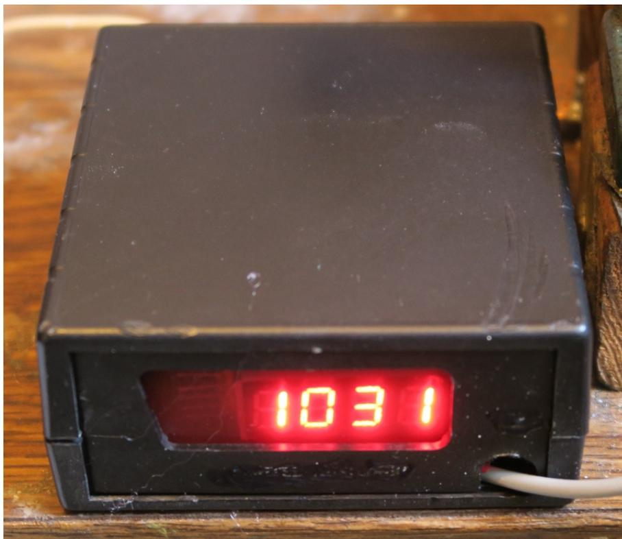
Il mesure des vitesses de rotation de 20 à 9999 t/min
