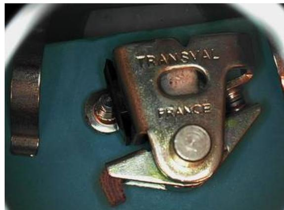
l'allumage transistorisé évite l'usure et le décalage du point d'allumage, mais il n'est pas utilisé avec un volant magnétique L'écartement maximal des grains du rupteur lui permet de résister à la pointe de tension de 200 à 400V (en plus, dans le cas de l'allumage batterie, de déterminer le dwell)
