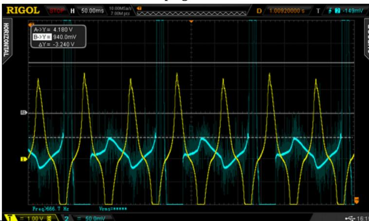
Tension bobine allumage et tension bobine éclairage (jaune) pour vérification de la sortie éclairage, en charge sur 6 Ω
