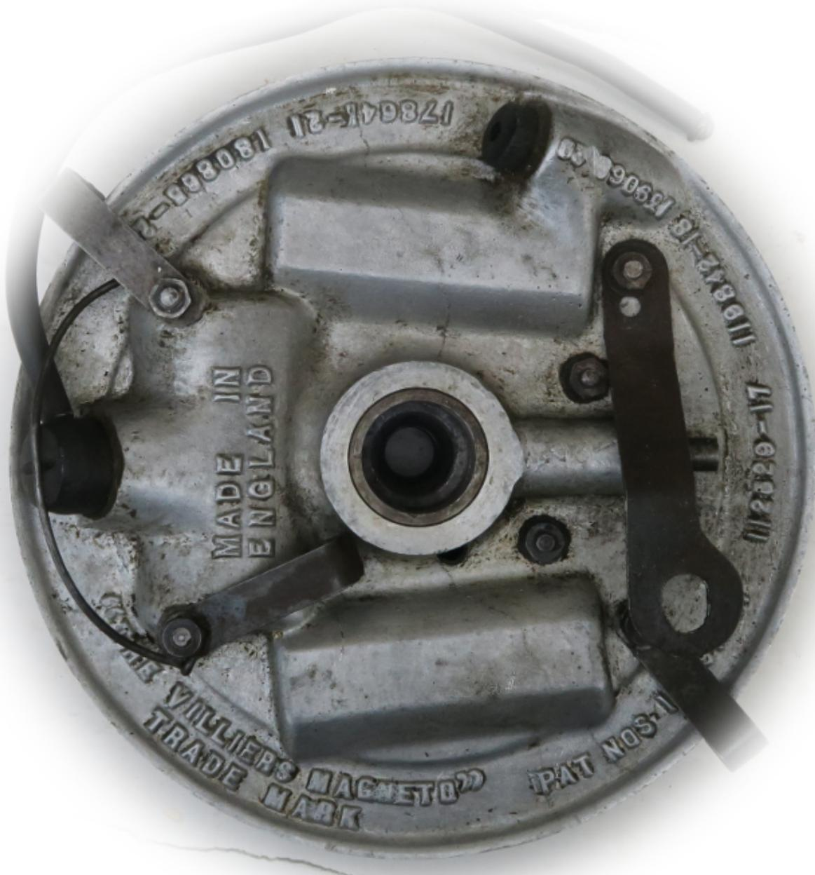
L'avance est réglable, le porte-bobine tourne sur le moyeu et est verrouillé en position par une découpe en secteur circulaire de la fixation. Même si ça s'appelle magnéto, ce n'est que le nom anglo-saxon et il ne possède pas d'éclateur de limitation, il y a de la place ici et on peut respecter largement les distances d'isolement.
