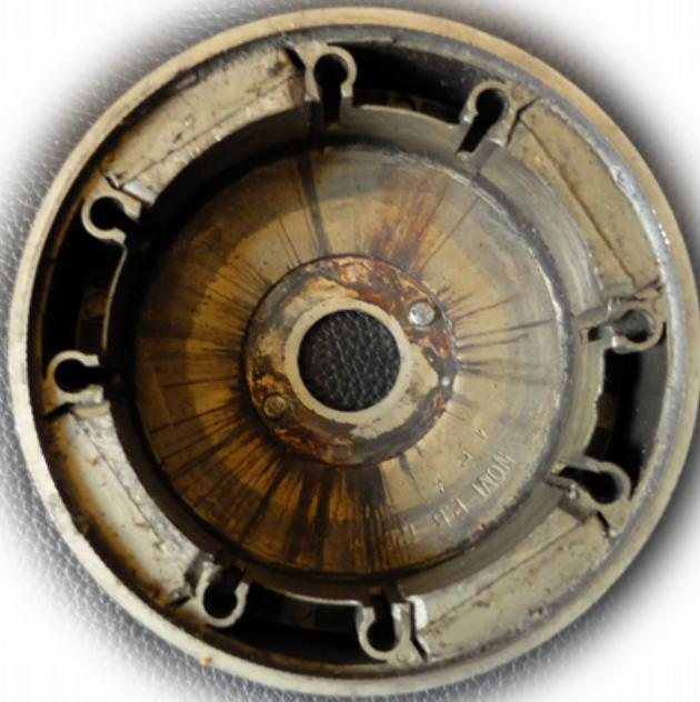
Les quatre demi-aimants d'un volant Mobylette (un pôle N, un pôle S, un pôle N et un pôle S). On y voit des aimants parallélépipédiques, associés à des pièces polaires adaptant les faces planes des aimants pour créer un entrefer cylindrique. L'aimant est donc magnétisé entre ses deux faces: un pôle se trouve vers la carcasse extérieure du rotor, l'autre pôle est dirigé vers la pièce d'adaptation plan- cylindrique vers le stator
