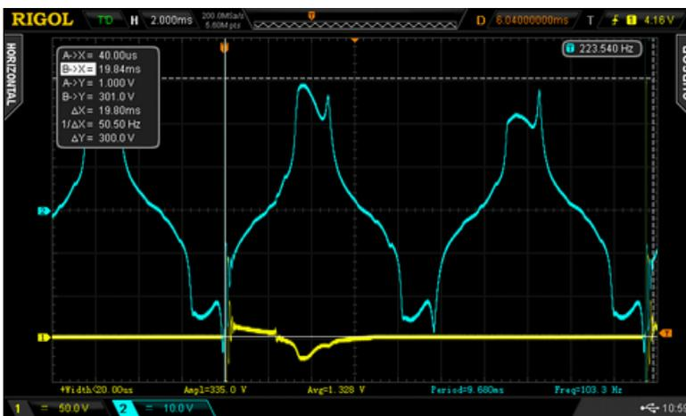
A 3000 rpm (50Hz) le rupteur s'ouvre près d'un maximum de tension
